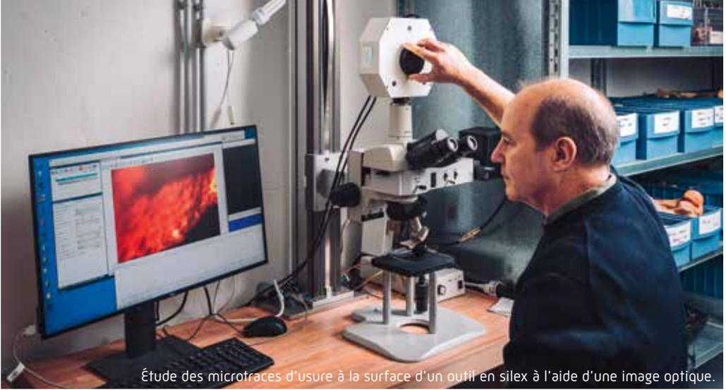
Étude des microtraces d'usure à la surface d'un outil en silex à l'aide d'une image optique.
